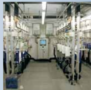
32 teljesen automatizált öblítőtartály tesztállvány
